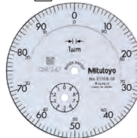
Graduación: 0.001mm Intervalo de medición: 1mm
