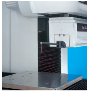
Detector de intervalo amplio utilizando tecnología de control activo
