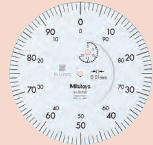
Graduación: 0.01mm Intervalo de medición: 20mm 3050S
