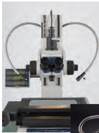
A: Iluminación vertical de superficie (Halógena)
