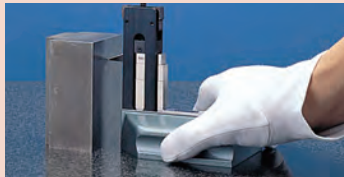
Marcando una pieza usando la base, un sujetador y la punta para trazar
