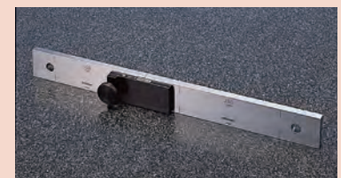
Agujeros para acoplamiento en bloques patrón
