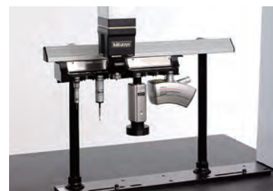
Nota: Si no utiliza ACR3, la sustitución del palpador se realiza manualmente.
