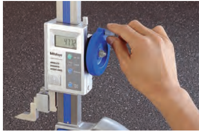
Suave deslizamiento del cursor con manivela
