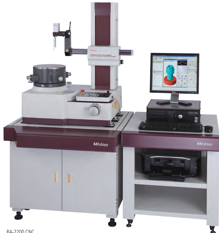
RA-2200 CNC Aislante de vibración del sistema (con mesa auxiliar)
