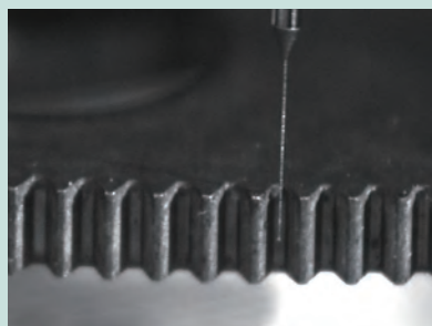
Forma de medición de los dientes del micro engrane
